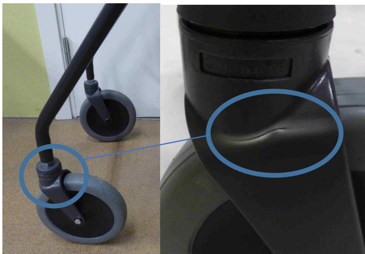
Fig 1: Tecken på en begynnande spricka. (vit missfärgning i materialet.)
